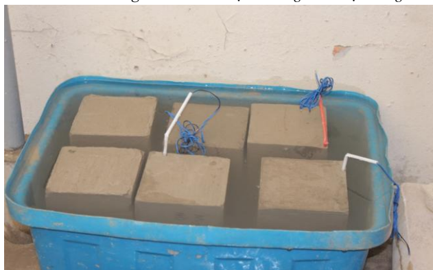
Hình 6: Công tác dưỡng hộ mẫu cột thí nghiệm
